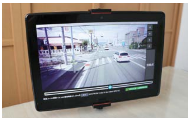
GPSと連動し走行場所の平常時の状況を映し出す。 マンホールには赤い警告が出されている。
